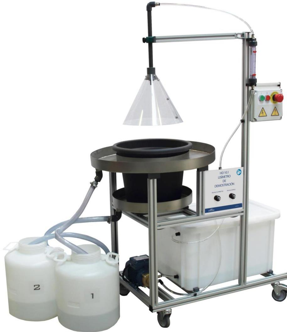
Con el equipo HD 10.1, se trata de conocer la capacidad de retención de agua de un suelo mediante el empleo del balance hidrológico, diferenciando cada uno de sus elementos.
