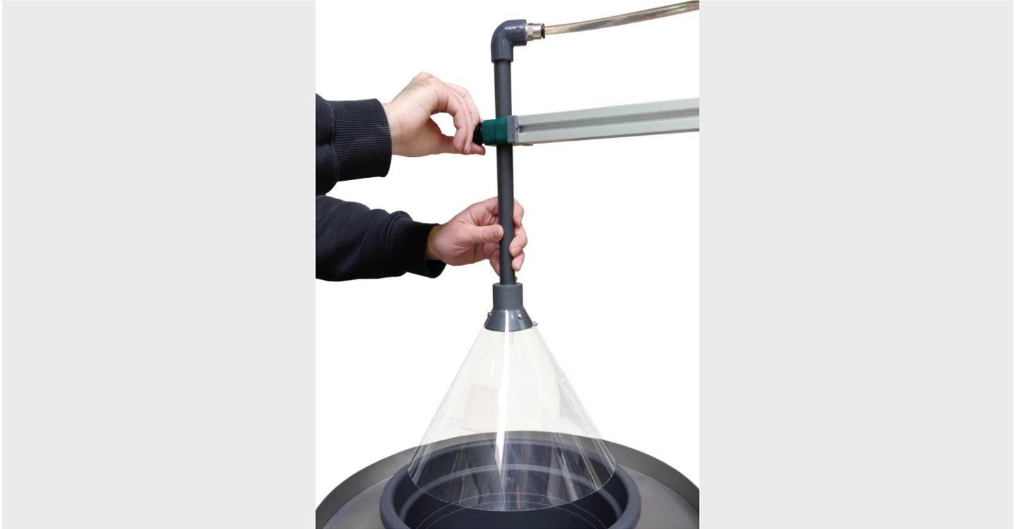
El equipo permite ajustar la altura del difusor para posicionarlo correctamente en función del caudal utilizado.
